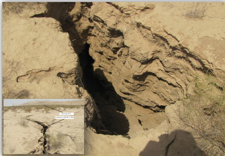
شکل ۲- نمونه‌ای از ابعاد شکاف‌های فرونشستی محدوده ورامین
